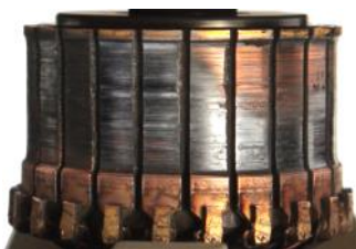
Bild: Skadad kollektor
